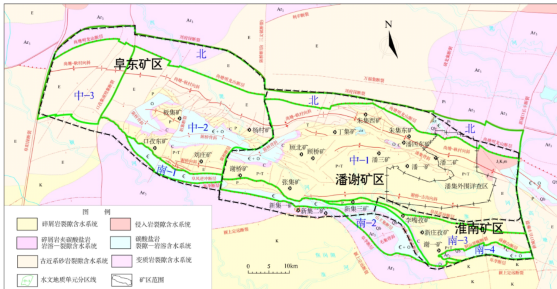
图 6.1.2-1 淮南煤田基岩水文地质单元分区略图
